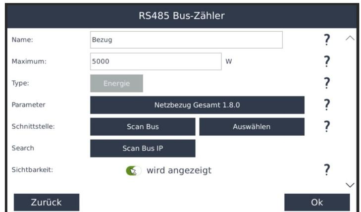
Bei „Schnittstelle“ drücken Sie auf „Scan Bus“. Wählen Sie bei der Auswahl z.B.: „1\_1\_GAVAZZI-EM24DIN“.
